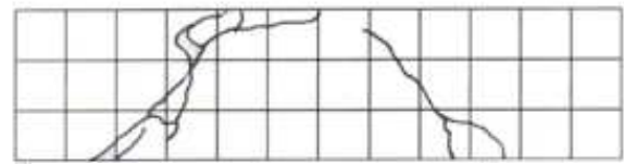
Gambar 14 Pola Retak Balok BCF-3
