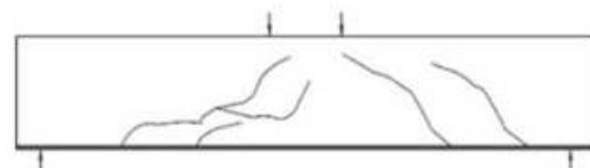
Gambar 15 Pola Retak Geser pada Balok
