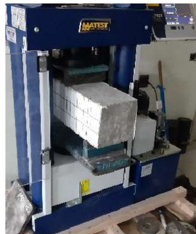
Gambar 2 Pengujian Lentur Balok
