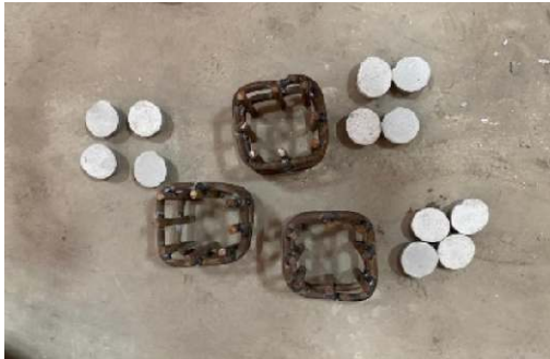
Gambar 1 Penulangan pada Benda Uji
