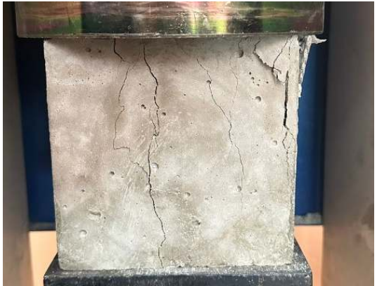
Gambar 8 Benda Uji Kubus 15 cm dengan Variasi Jarak Sengkang, s = 5 cm
