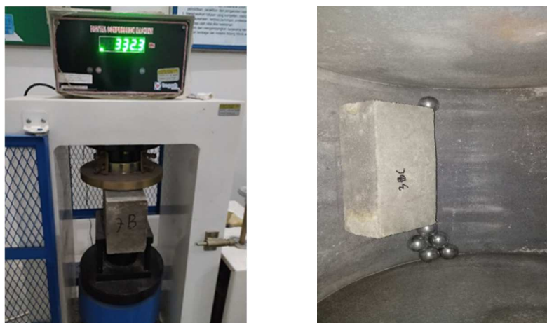
Gambar 2. Uji kuat tekan batako dan Uji ketahanan aus batako
