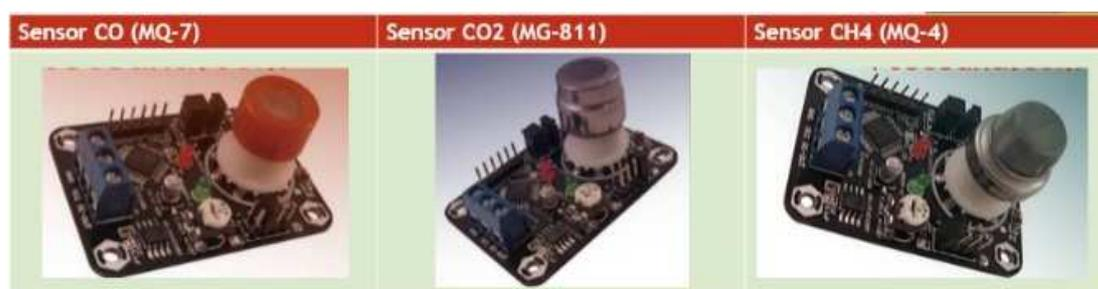
**Gambar 1.** Foto modul sensor gas berbasis Arduino untuk pengukuran konsentrasi gas CO, CO<sub>2</sub> dan CH<sub>4</sub> dalam luaran produk sintesis *Fischer-Tropsch*
