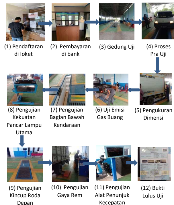
Gambar 18. Alur Pengujian Kendaraan Bermotor dengan Sistem BLUE
